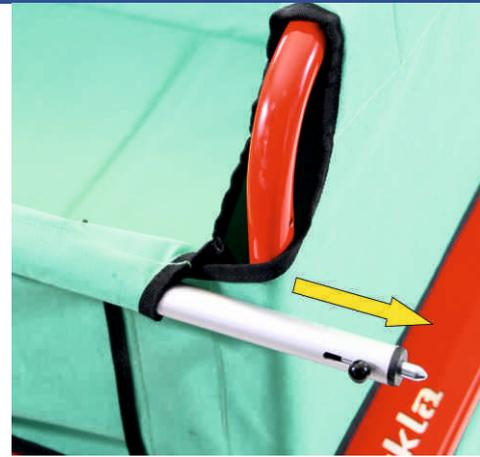
Demontage der seitlichen Haltestangen / disassemble of the side holding bars
